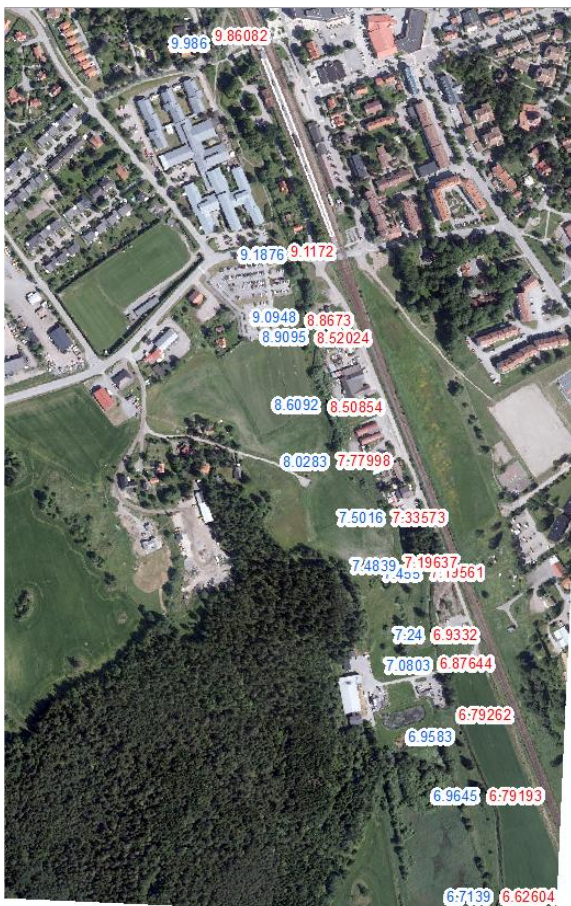
Figur 13. Inmätta vattennivåer 2017-02-01 (blå text) och beräknade vattennivåer (röd text) vid LLQ = 6 l/s.
