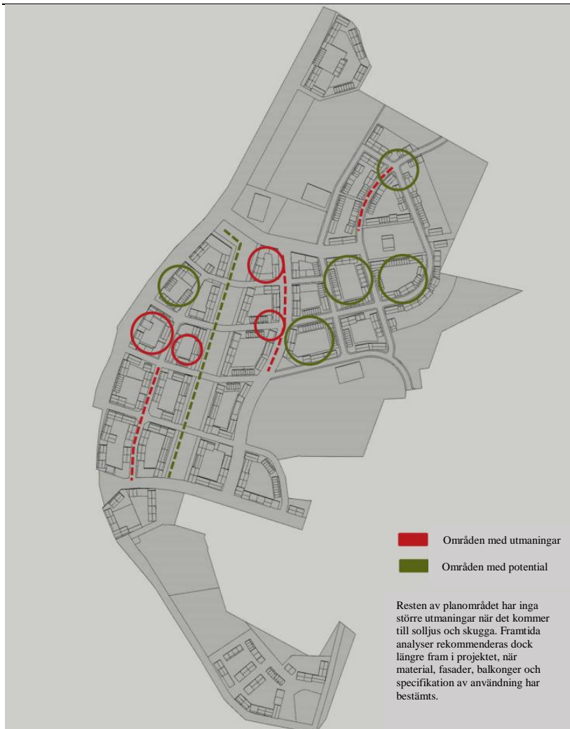
Figur 8: Platser utpekade i solstudien där solljuset bör särskilt tas i beaktning. Kritiska platser markeras med rött och platser med goda solförhållanden i grönt. Källa Solstudie: Urban Daylight Study for Alsike 2018-05-31
