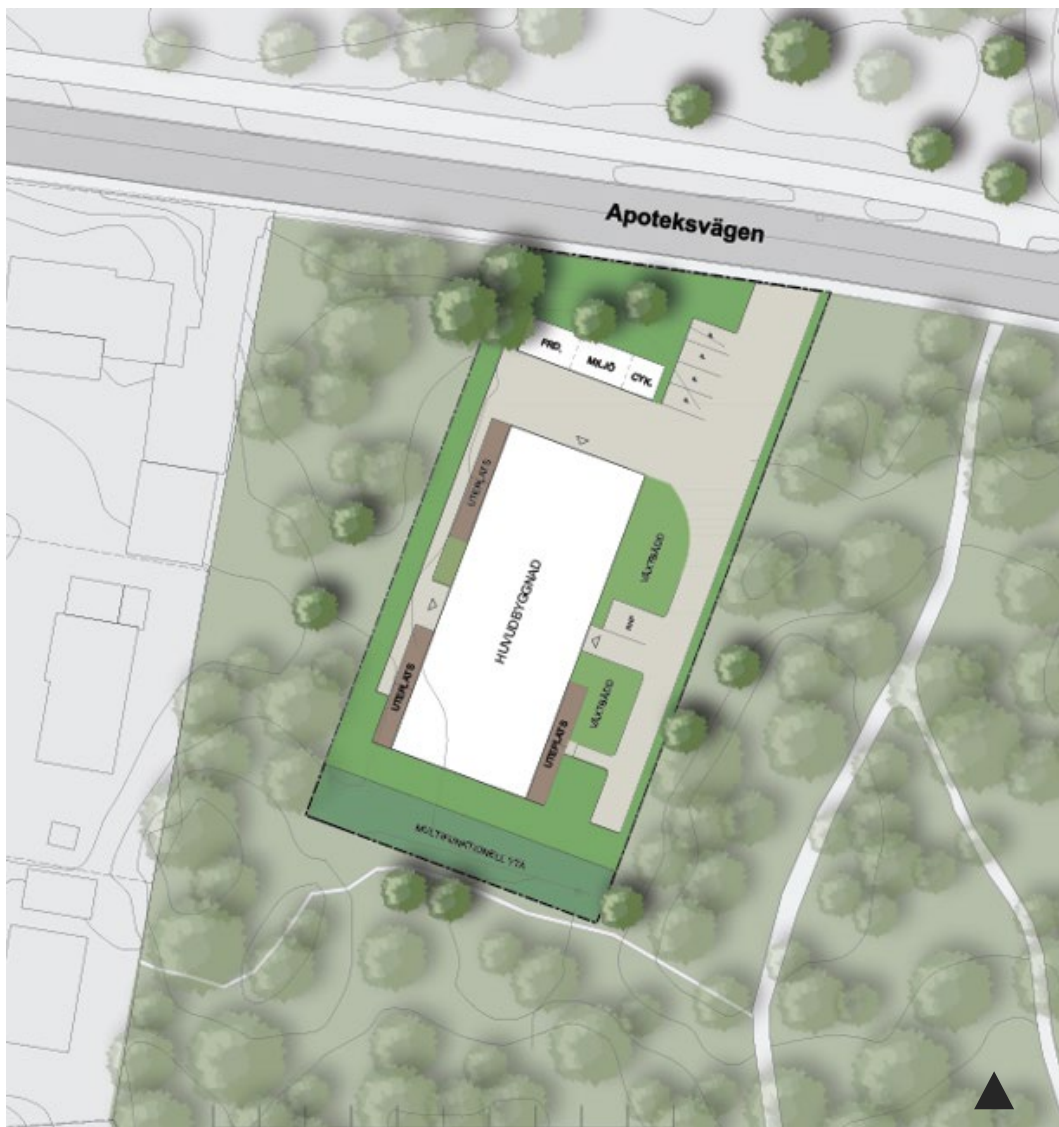
Figur 7: Illustrationskarta som visar huvudbyggnad om cirka 585 kvadratmeter och komplementsbebyggelse om cirka 65 kvadratmeter, White 2024.
